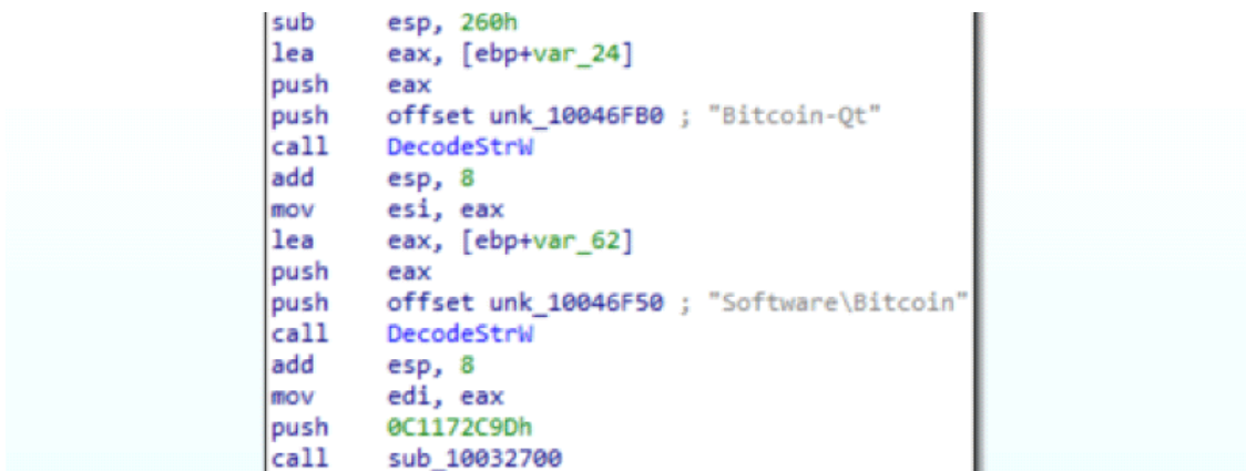
図6 Bitcoin-Qtのデータを窃取対象とするためのコード (バージョン1.6.28.0)
