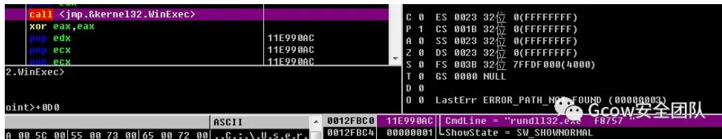
图片14 使用rundll32.exe加载导出函数f8757
